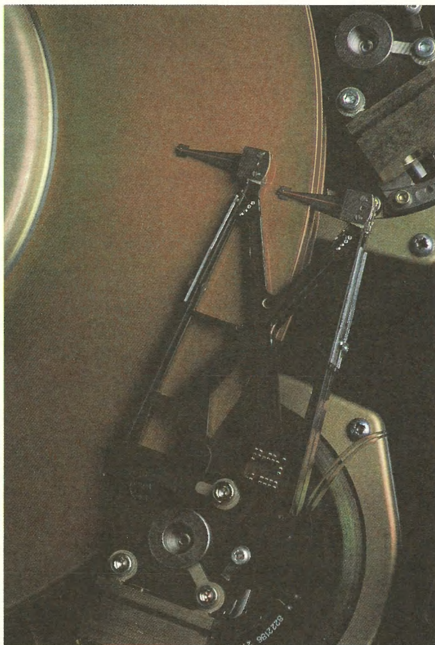
В НАКОПИТЕЛЕ НА МАГНИТНЫХ ДИСКАХ, созданном фирмой IBM, применены тонкопленочные электромагнитные головки (на концах треугольных держателей), позволяющие записывать данные быстро и с высокой плотностью.
